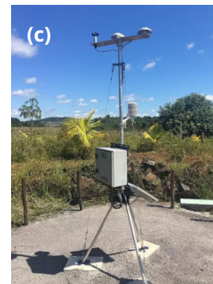
Figura 2.8 - Plataformas de coleta de dados solarimétricos: (a, b) plataformas destinadas a pesquisa, (c) plataforma que atende aos requisitos da EPE (2021).
